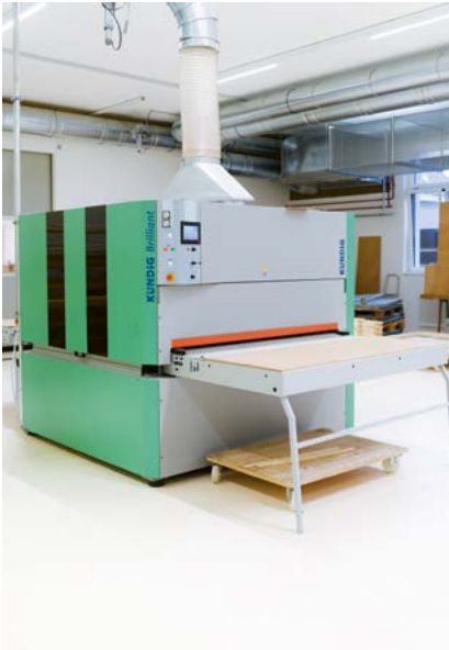
Malgré sa grande largeur de travail de 1600 mm, la machine est compacte.
