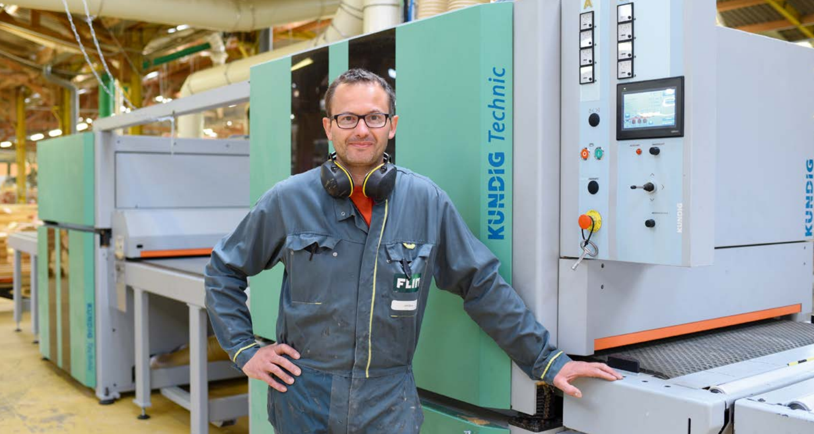
Didier Jean, chef d'équipe, un homme et sa machine: la Kündig Technic Botop 8 peut poncer en un an et avec un seul employé les matériaux nécessaires pour environ 10 000 escaliers.
