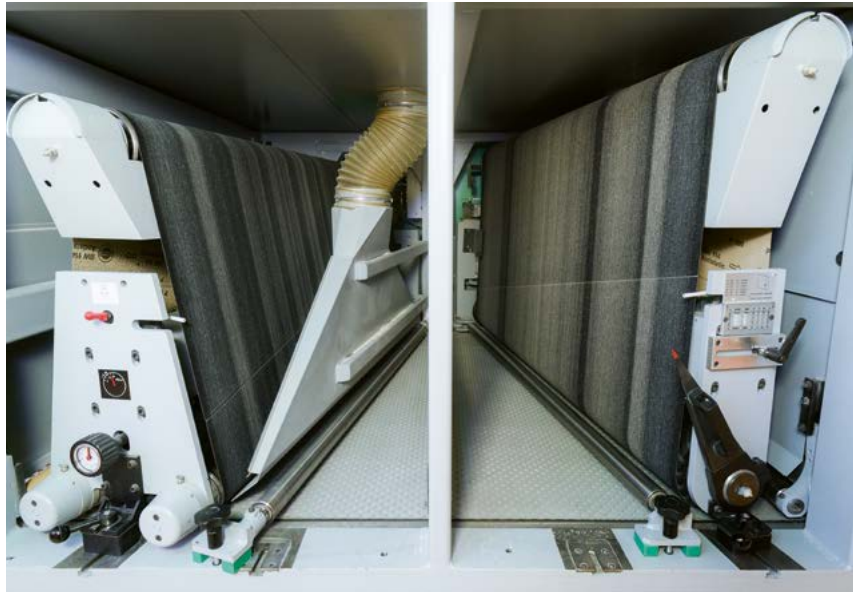
Les unités disposées en V permettent d'introduire les cadres en ligne droite et d'utiliser pleinement la largeur de la machine. De plus, les surfaces sont plus lisses.
