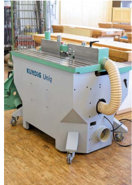
Le châssis très stable permet de rendre la machine mobile en l'équipant de roulettes.
